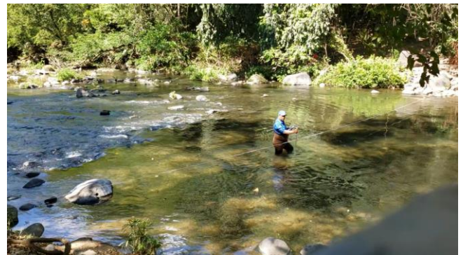
Figura 3. Medición por vadeo en una sección transversal de río de la red hidrométrica de MARN/DOA.
